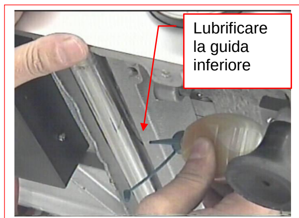
Figura 43 – Lubrificazione guida inferiore
