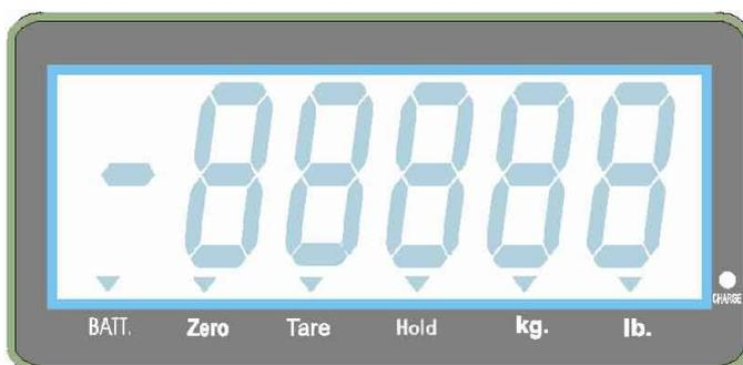
**BATT:** indicatore batteria. Quando il display mostra l'indicazione della batteria dovrebbe essere ricaricato.
