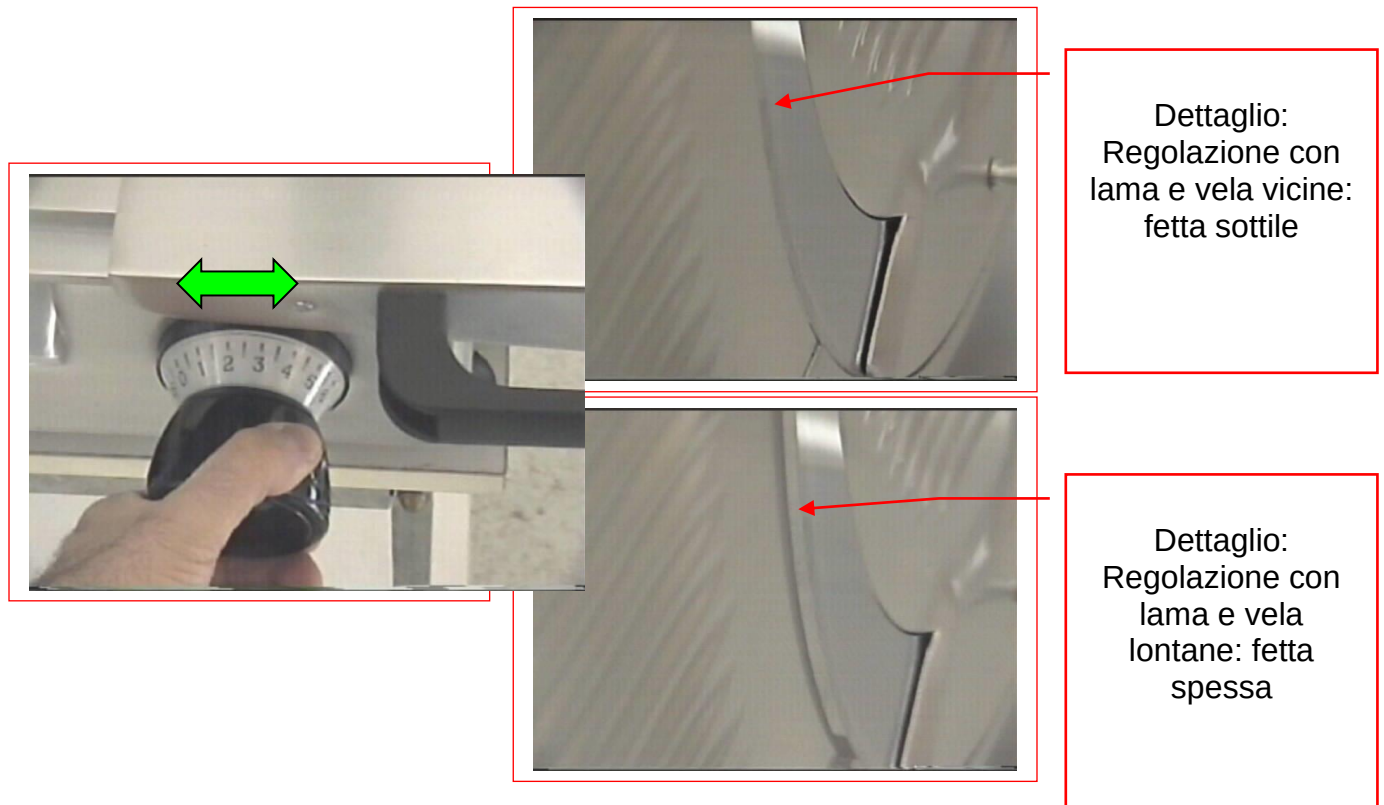
Figura 20 - Regolazione dello spessore
