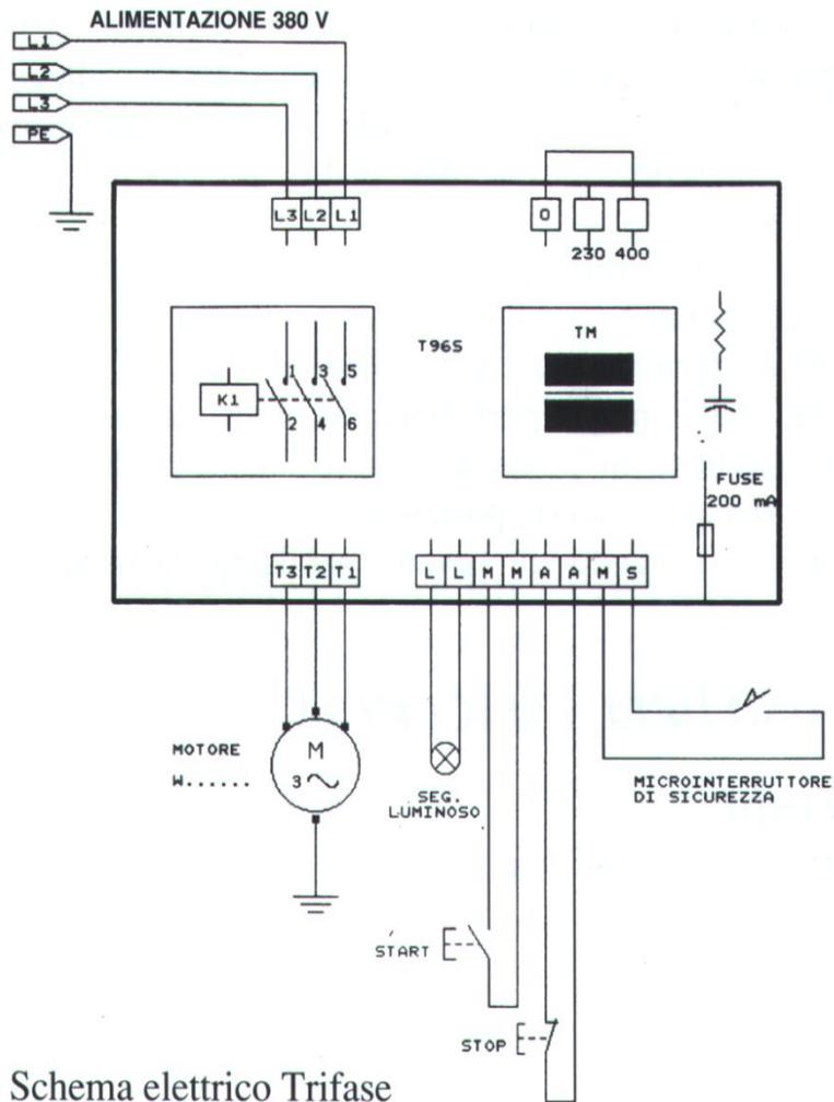
FIG. n°6 - Schema elettrico Trifase
