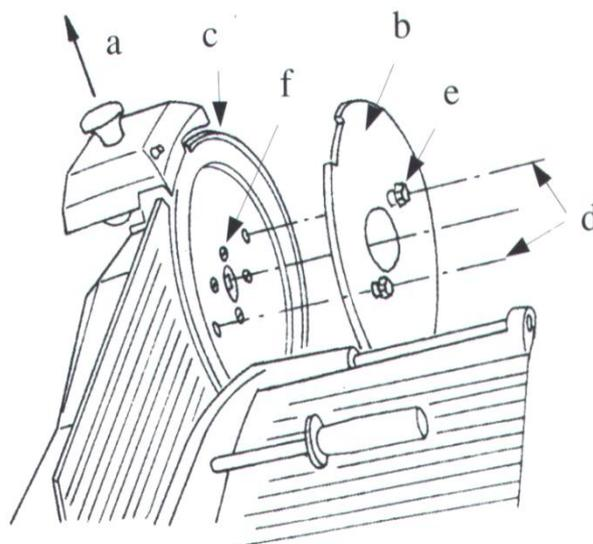
FIG. n°12 - Posizionamento della maschera per estrazione
